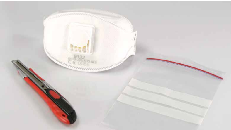
Material für Probenahme bei Fensterkitt und Bodenbelag aus Kunststoff
