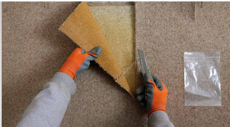
Probenahme bei altem Kunststoff-Bodenbelag (z. B. unter Teppich): bei mehrschichtigen Belägen alle Schichten erfassen, dazu gehört immer der Kleber
